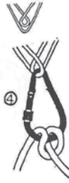
4) Il assure le Second par le Demi-noeud d'amarre sur le mousqueton (6 kg pour freiner 100 kg)
